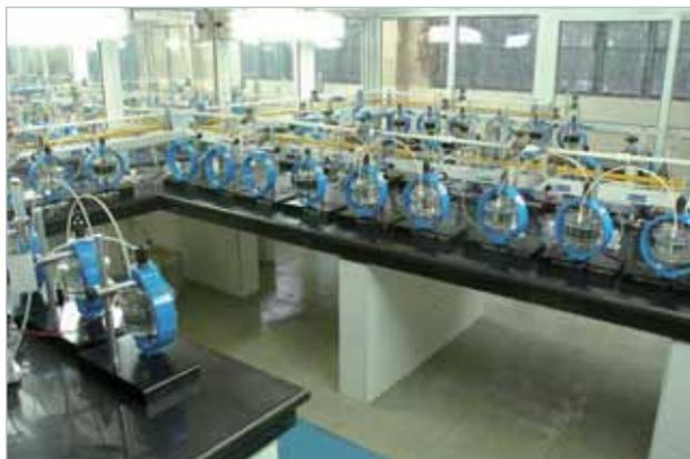
▲ H<sub>2</sub>S腐蚀实验设备
