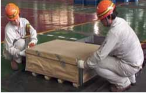
④ 拆卸钢护角
