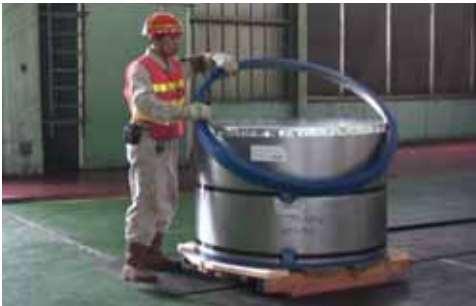
拆卸铁外护角
