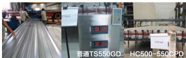
宝钢开发的先进高强新产品受到用户欢迎，压型加工正常，风揭试验在宝钢用户美联试验室完成。美联钢构对压型钢板风揭强度的要求是大于4.0Kpa。宝钢先进高强钢HC500/550CPD+AZ，当风压至达到2.5Kpa持续保持风压30S时，观察钢板表面有发生塑性变形；当风压至达到6.0Kpa时，压型钢板在螺钉紧固处发生破坏，螺钉孔扩大，钢板被撕裂，钢板从螺钉头部脱开，螺钉完好保持在檩条上。同等工况条件下，宝钢TS350GD彩涂钢板抗风揭强度为4.19Kpa，0.53毫米厚度宝钢TS550GD的PBR-1026压型钢板极限破坏风压值为3.96Kpa。
