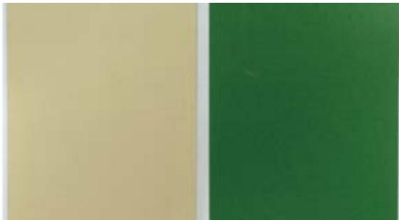
超厚氟碳双面涂层彩涂钢板上表面涂层厚度超过60微米，有着优异的耐蚀性和耐候性，该产品背面也为氟碳涂层，底漆厚度超过普通氟碳钢板的底漆，因此耐蚀性也非常优秀，特别适用于内外环境均较为苛刻的场合，例如：近海岸1km内（码头、港口设施）、长年潮湿环境、室内外腐蚀性环境（电厂、铝厂等）。
