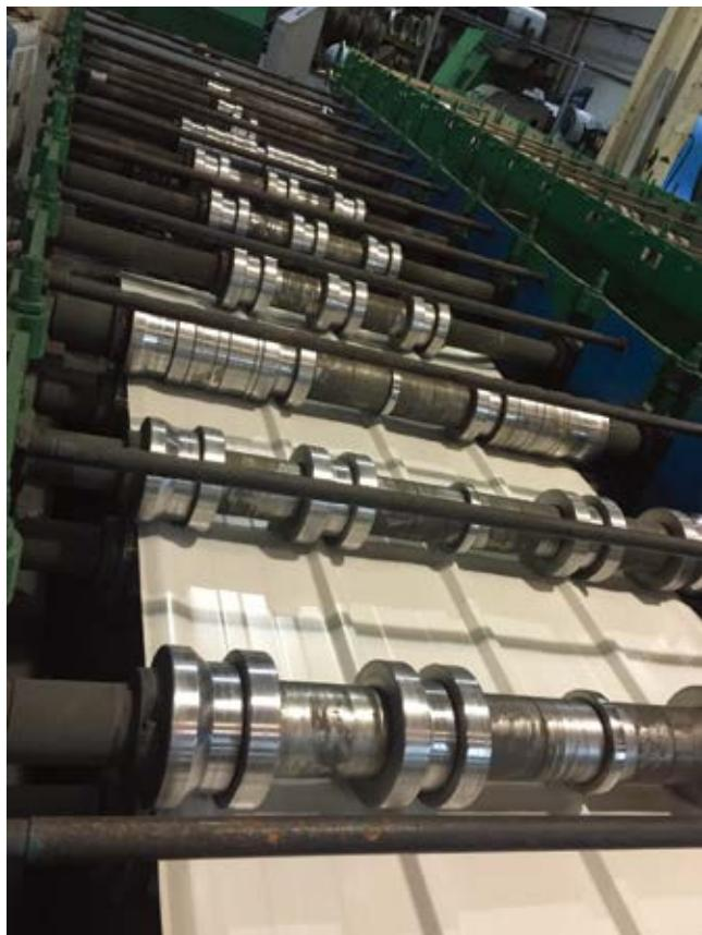
为了评估高铝锌铝镁（BAM）彩涂钢板在建筑用途的使用情况，我们分别在不同用户处进行了加工，均能满足用户辊压成型，折弯（包括180度折弯）成型等加工要求。
