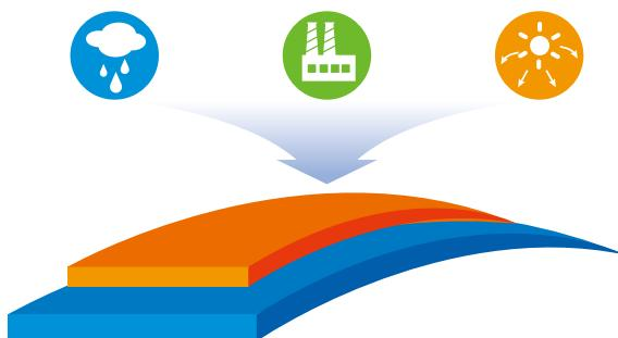
彩涂钢板的失效过程如下图所示，涂层失效、镀层失效乃至钢板穿孔是关键的腐蚀发生过程。因此提高涂镀层厚度，且采用耐候、耐蚀涂镀层是最有效的防止彩涂钢板腐蚀失效的手段。
