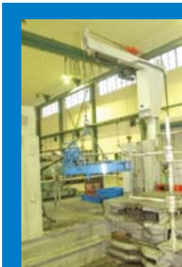
上卸扣试验机 Make-and-break Test Machine
