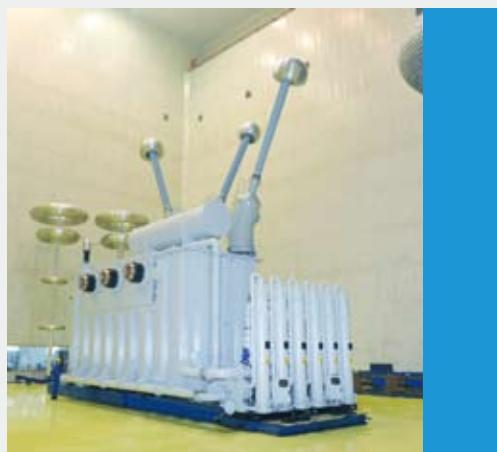
保变——向家坝水电主变压器 SSP-890MVA/500KV
