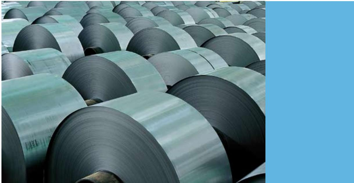
电工钢主要分为晶粒取向电工钢和晶粒无取向电工钢两大类。取向电工钢易磁化晶粒方向沿轧制方向分布，轧制方向具有高磁感、低铁损及低磁致伸缩等优良特性，同时还可通过磁畴细化的技术处理，获得更低铁损的性能，广泛应用于变压器行业领域。
