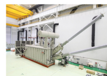
±800kV直流变压器 ±800kV DC transformer
