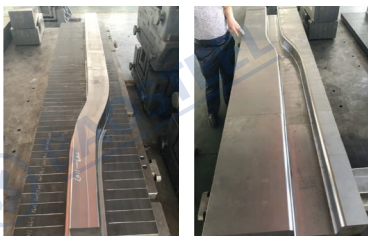
여분의 긴 빔 전체적으로 롤 성형 다이 개발 Die design of roll-stamping whole super long longitudinal beam
