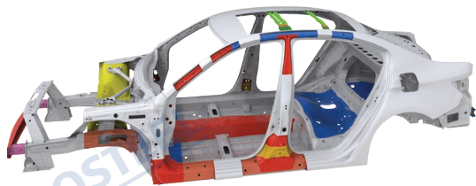
图2 先进高强度钢应用的主要零件示意图（宝钢超轻型白车身）
