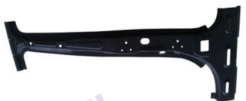
图20 热冲压B柱，HC950/1300HS，1.8mm×1025mm
