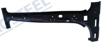
그림20 핫프레스포밍 B필러 HC950/1300HS, 1.8mm×1025mm
