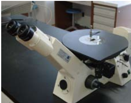
AXIOVERT25CA 金相显微镜 AXIOVERT25CA metallographic microscope
