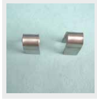
图4 晶间腐蚀试样冷弯后形貌
