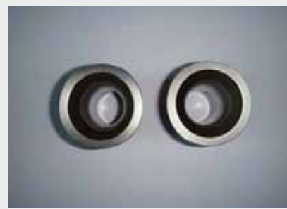
图 10 宝钢 TP310HCbN(S31042) 扩孔试验
