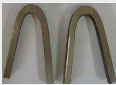
图 12 宝钢 TP310HCbN(S31042) 弯头试验
