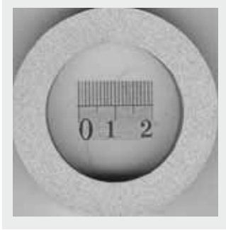
图1 钢管低倍组织照片
