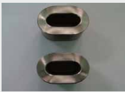
图 11 宝钢 TP310HCbN(S31042) 压扁试验
