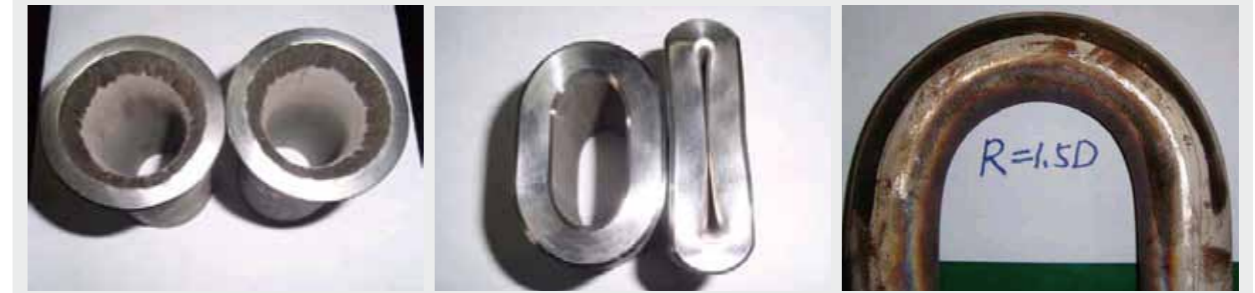
图 10 宝钢 S30432 扩孔试验
