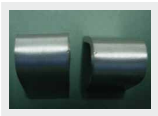
图 4 晶间腐蚀试样冷弯后形貌
