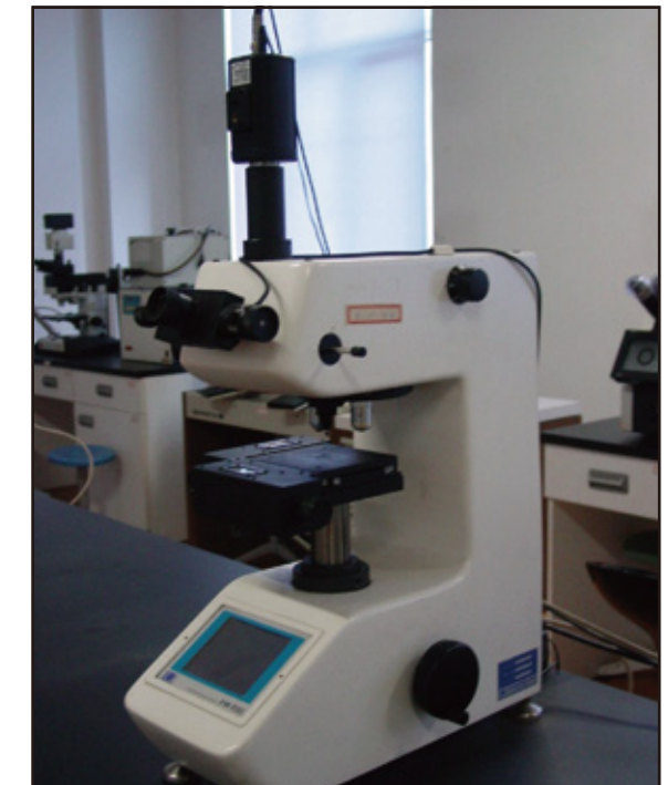
显微硬度计FM-700D FM-700D microhardness tester
