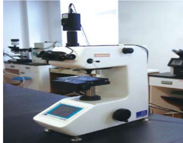
显微硬度计FM-700D FM-700D microhardness tester
